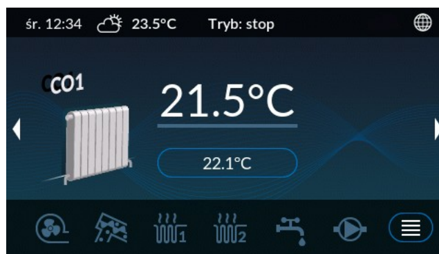
Ilustracja 11: Ekran obwodu CO.1
